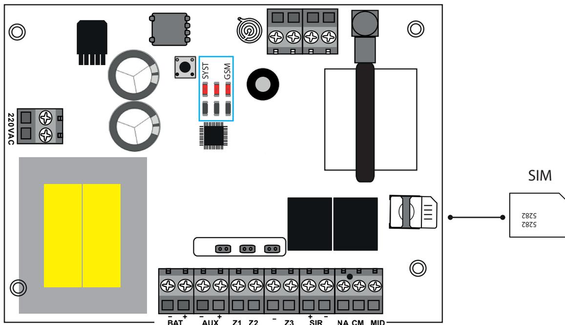
2. Insertar el chip en el panel Unicom, después colocar la batería de 12V y por último enchufar a la alimentación de corriente 220V.
