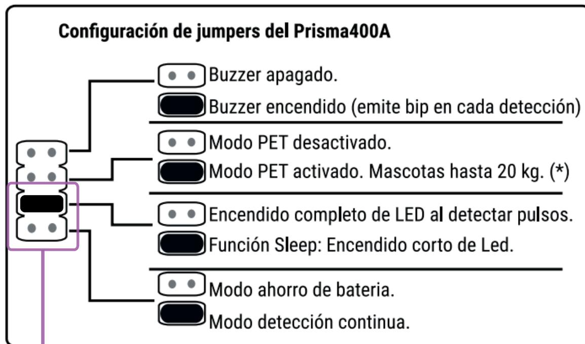
La combinación de las últimas 2 posiciones de Jumpers activa el modo de ahorro de batería en 4 min. aprox. y encendido corto de LED Minimizando el consumo de batería en disparos de áreas con mucho tránsito de personas.
